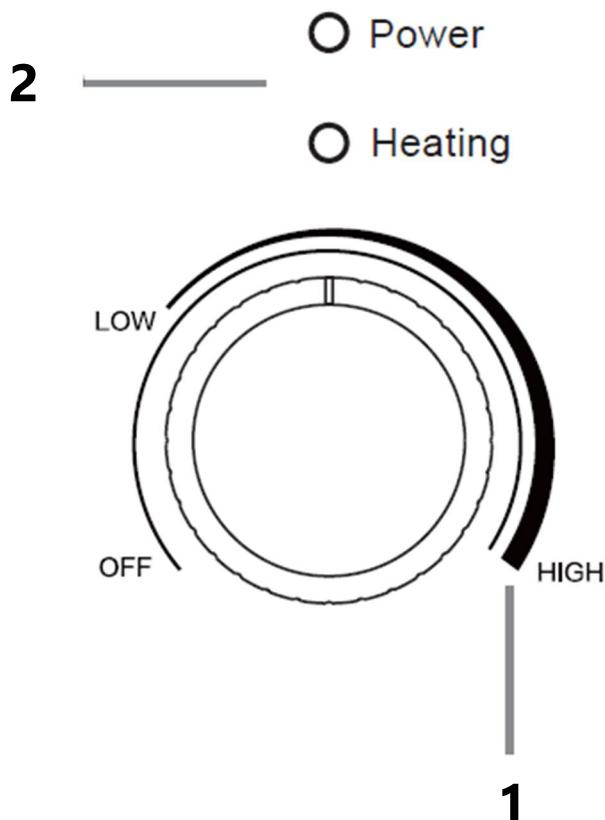
1. Ручка для включения/выключения нагрева и установки температуры нагрева.
