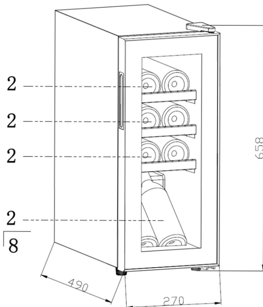
Винный шкаф снабжен съемными полками для удобного хранения вина. Вместимость данной модели винного шкафа составляет 8 бутылок (стандартные бутылки формы «Бордо», объем 750 мл).
