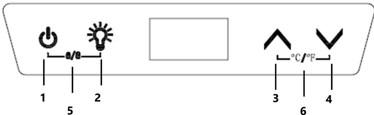
Обратите внимание, что при подключенном питании, панель управления прибора по умолчанию заблокирована. Для разблокировки нажмите одновременно на кнопки «Включение/Выключение» и «Подсветка» и удерживайте нажатыми в течение 3 секунд.
